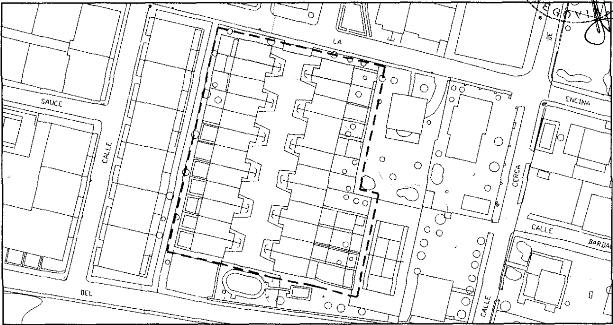
Ejemplo de parcelación máxima tipo permitida por el planeamiento con frente a vía pública permitido de 5 metros mínimo .
